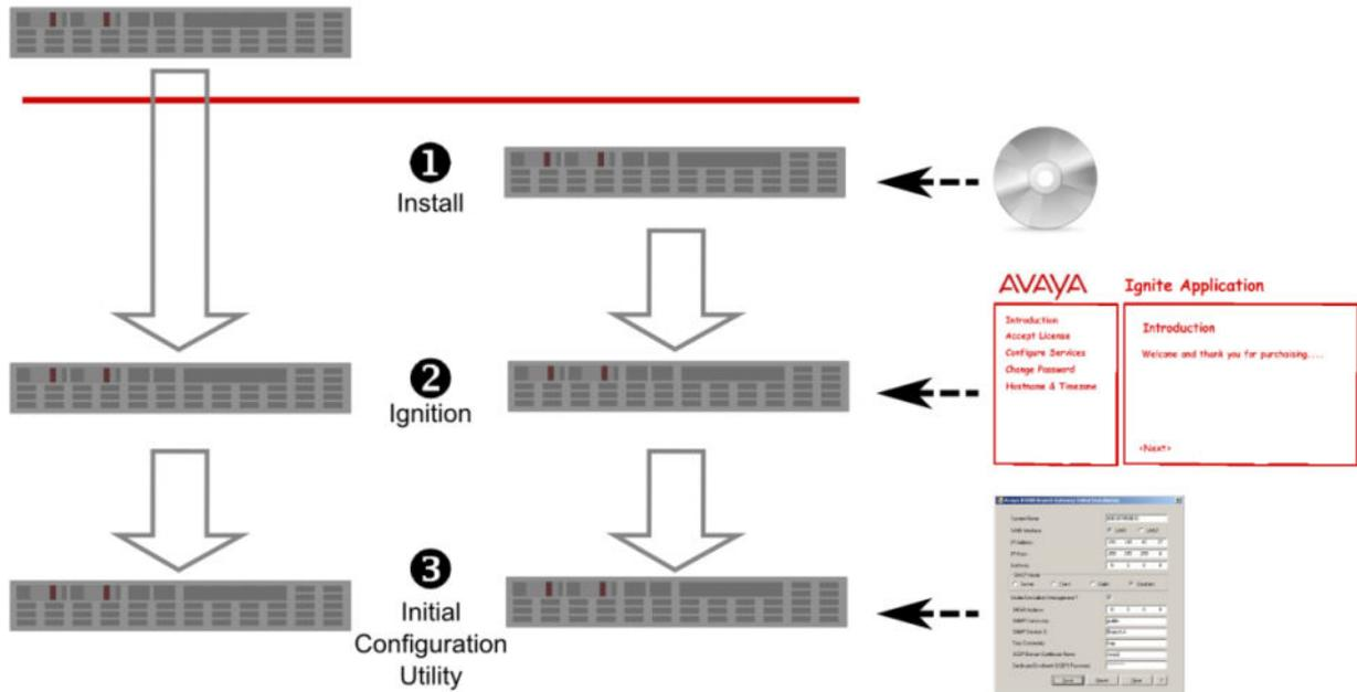
È possibile installare il software di una soluzione IP Office Server Edition Solution solo sui server supportati da Avaya. Avaya non fornisce alcun supporto per il software Server Edition installato su altri tipi di server. Per ulteriori informazioni sui server supportati da Avaya, vedere *Configurazione di riferimento per IP Office Server Edition*.
